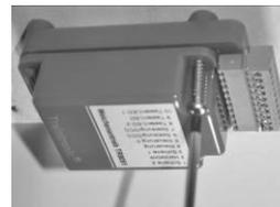
Zuerst wird der Weichenantrieb mit einer der entfernteren vier Schrauben befestigt. So ist es möglich, kleine Korrekturen durch drehen des Antriebs vorzunehmen.
