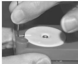
...das auf die erforderliche Länge zugeschnittene Verstärkungsrohr über den Stelldraht gestülpt und in die Bohrung geschoben.
