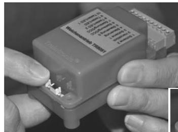
Mit den beiden Programmier Tasten wird die Stellscheibe in die richtige Position gebracht
